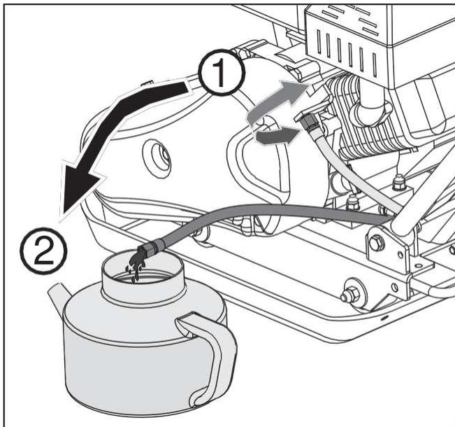
Работа двигателя с грязным маслом может привести к преждевременному износу и отказу двигателя. Регулярная замена масла крайне важна. Гибкий маслосливной шланг предназначен для слива масла в соответствующую емкость.
