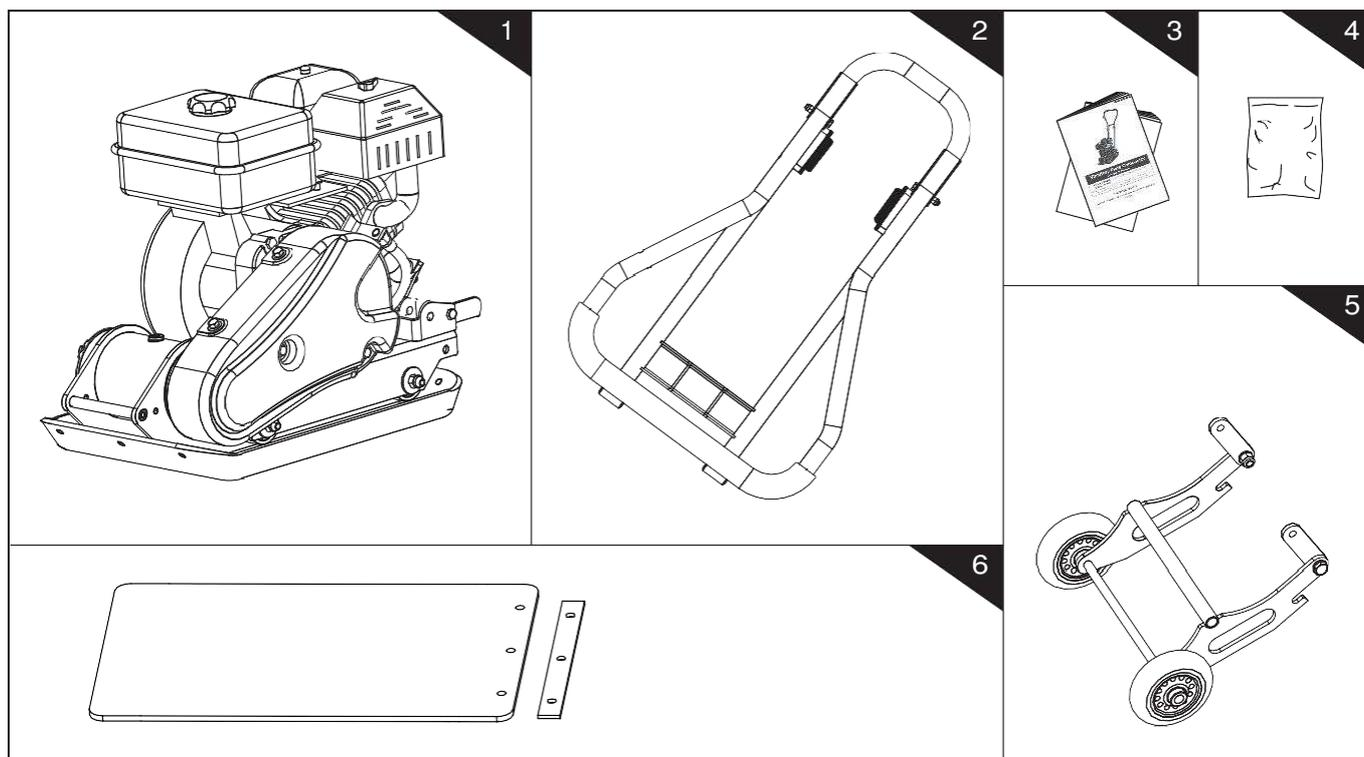
1. Рама трамбовочной плиты с двигателем и трансмиссией и баком для воды (опционально). Бак для воды обозначается в маркировке символом W.
