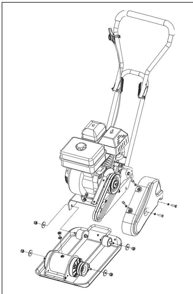
2. Снимите кожух ремней и ремни.
