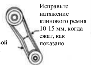
Рисунок 2. Натяжение клинового ремня
