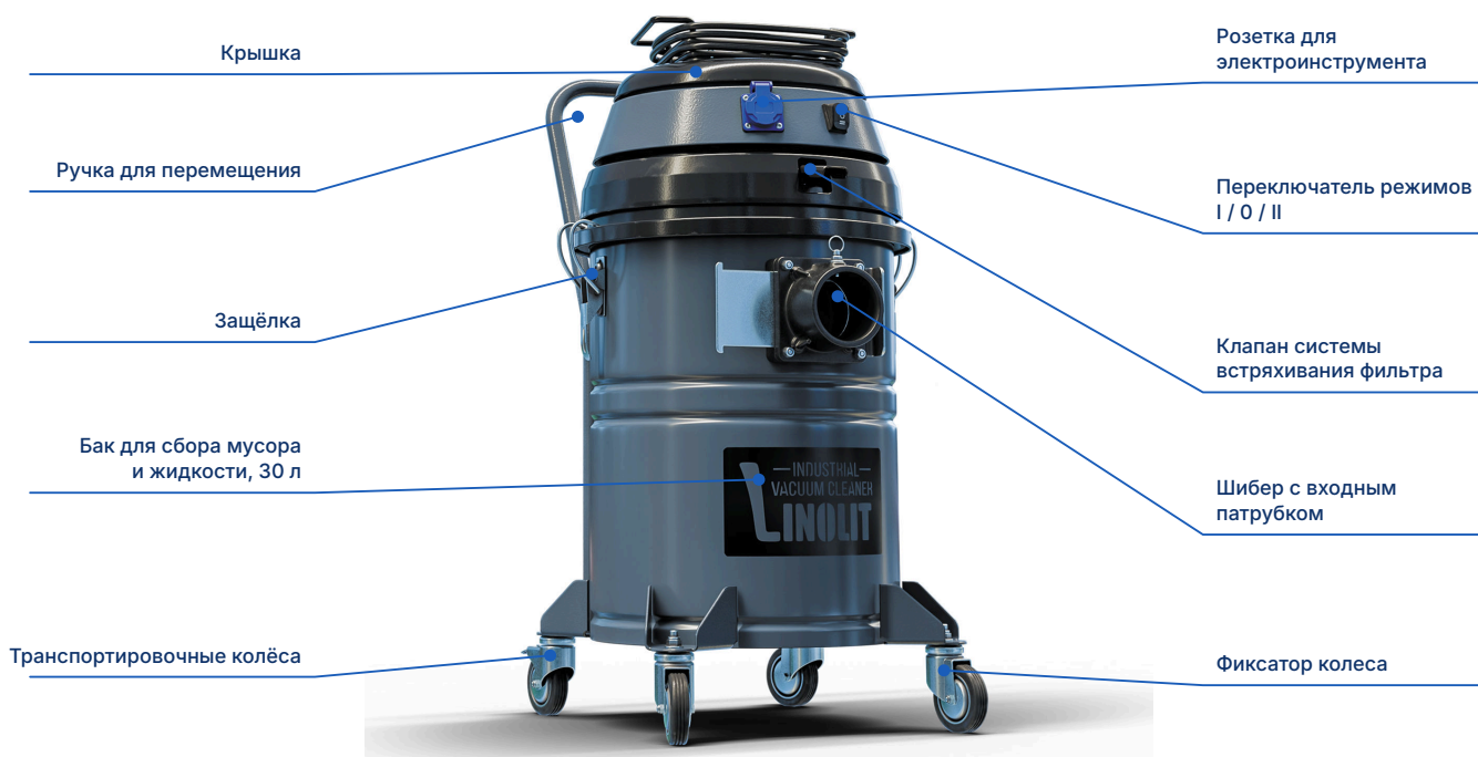
Рис. 1. Промышленный пылесос LINOLIT® D1 — общий вид и органы управления
