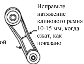
Рисунок 2. Натяжение клинового ремня
