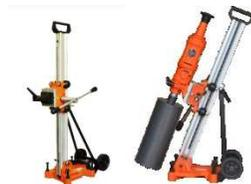
Стойка (станина) алмазного бурения Саукен КСУ-400F предназначена для использования с двигателем для сверления отверстий в бетоне, железобетоне, кирпиче, камне и других материалах с помощью алмазной коронки диаметром до 400 мм. Ход каретки 680 мм. Работа под углом, 0° – 45°.
