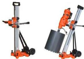
Стойка (станина) алмазного бурения Саукен MIN предназначена для использования с двигателем для сверления отверстий в бетоне, железобетоне, кирпиче, камне и других материалах с помощью алмазной коронки диаметром до 125 мм. Ход каретки 450 мм. Работа под углом, нет.
