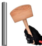
13. Стальная трубка и киянка для удаления керна из коронки
