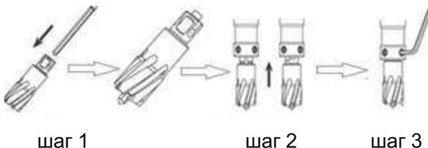
6.7 Установка корончатого сверла в держатель. Станок укомплектован держателем WELDON 19. Сверло вставляется хвостовиком в держатель (шаг 2). Установите шлицы напротив винтов и вставьте
