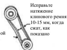
Рисунок 2. Натяжение клинового ремня
