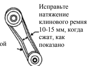
Рисунок 2. Натяжение клинового ремня
